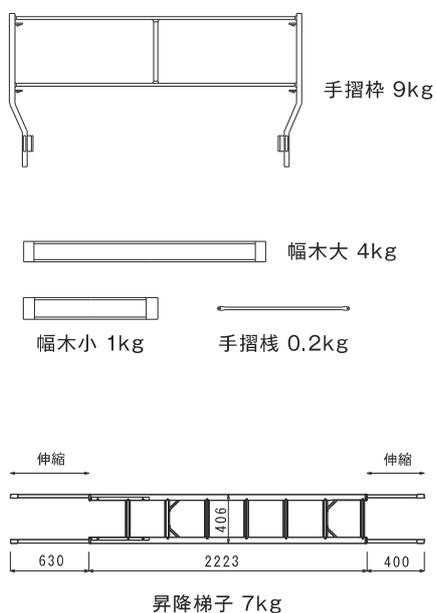
※ 使う時は必ず手摺棒、幅木、手摺棧、昇降梯子を使用してください。
